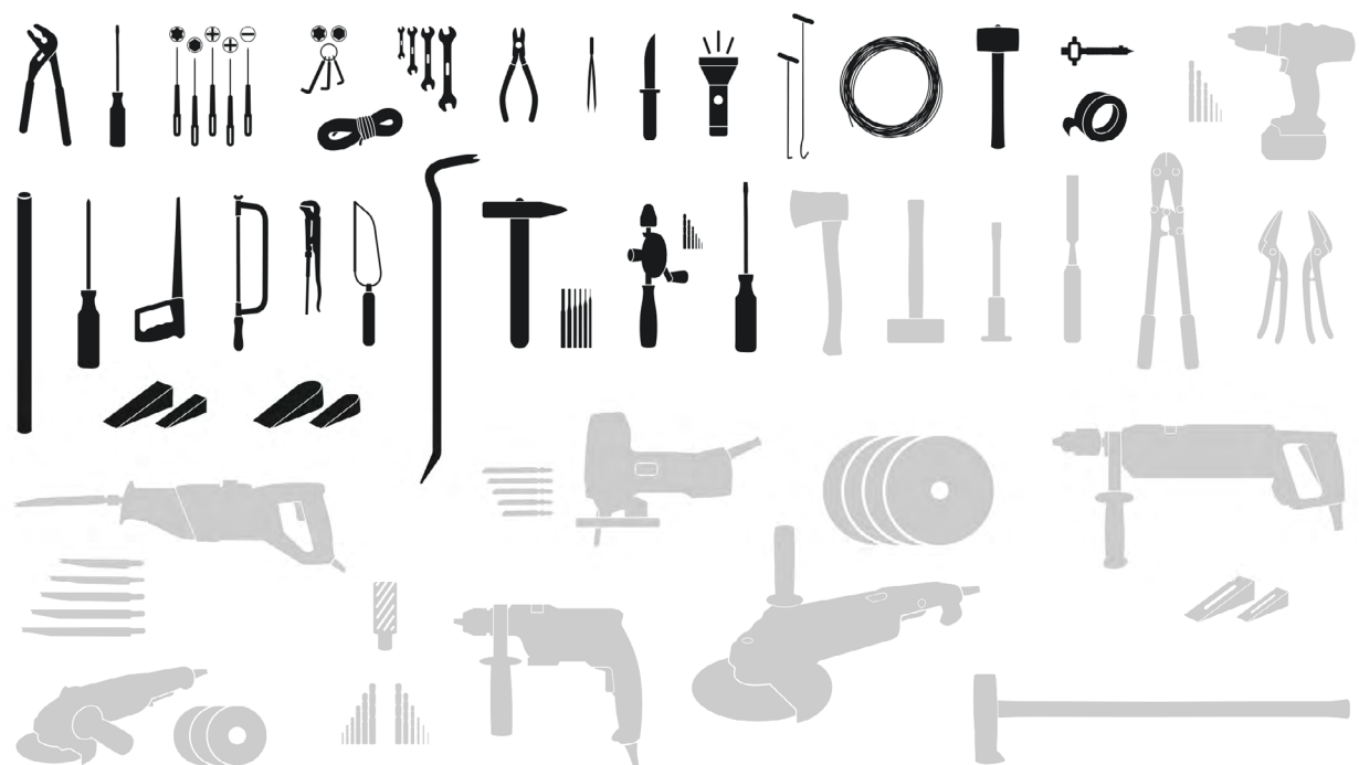
Auswahl an Werkzeugen für die praktische Einbruchprüfung RC1 bis RC3
